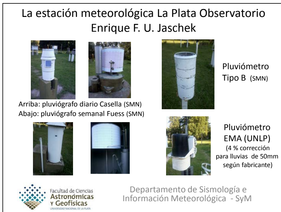
Figura 2: instrumental de LPO donde se mide y se registra la precipitación. (SMN: instrumental provisto por el Servicio Meteorológico Nacional, EMA: estación meteorológica automática marca Davis).
